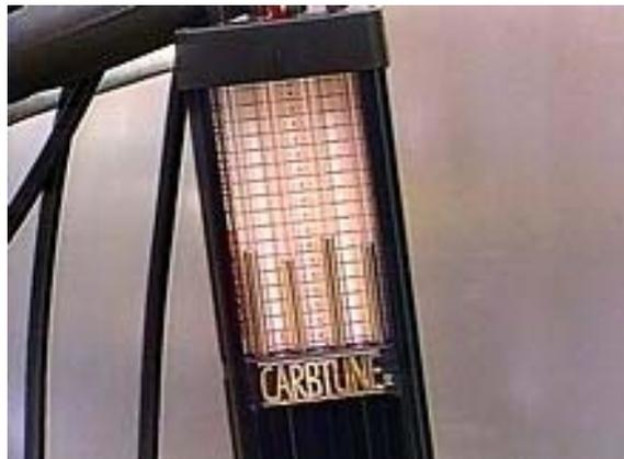
**3:** Faire tourner le moteur et déterminer quels carburateurs / injecteurs doivent être réajustés. S'il y a un carburateur de référence, les autres doivent être réglés pour lui correspondre. Régler l'admission de chaque cylindre jusqu'à ce que toutes les colonnes soient dans la tolérance des 2cmHg. Attendre quelques secondes après chaque retouche. Il est souvent nécessaire de mettre un petit coup de gaz pour contre vérifier la mesure sur le carburateur / injecteur qui a été ajusté.
